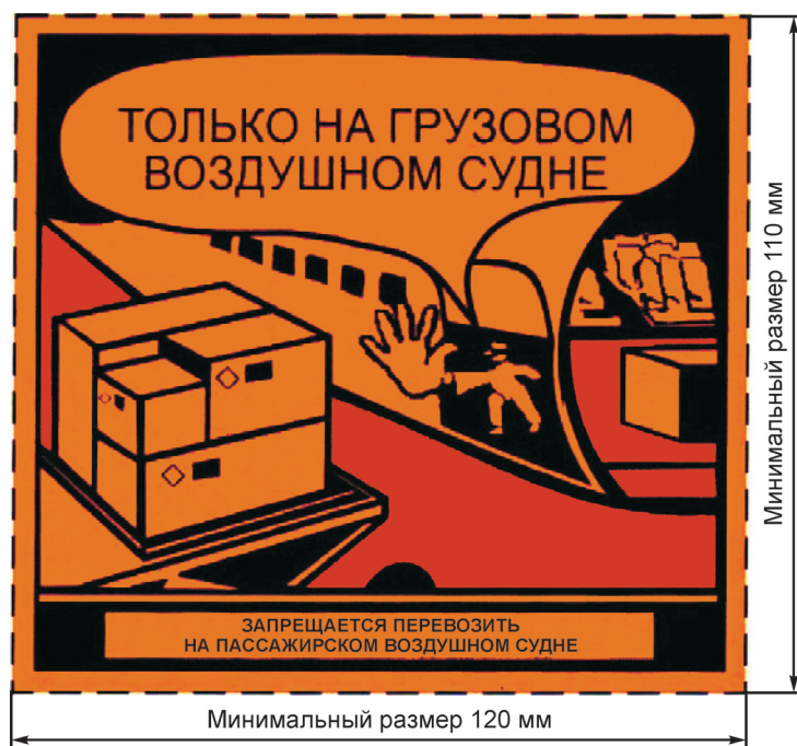
Рисунок 9.11 — Знак «Только на грузовом воздушном судне»
