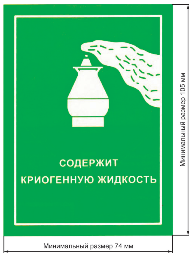
Рисунок 9.12 — Знак «Содержит криогенную жидкость»
